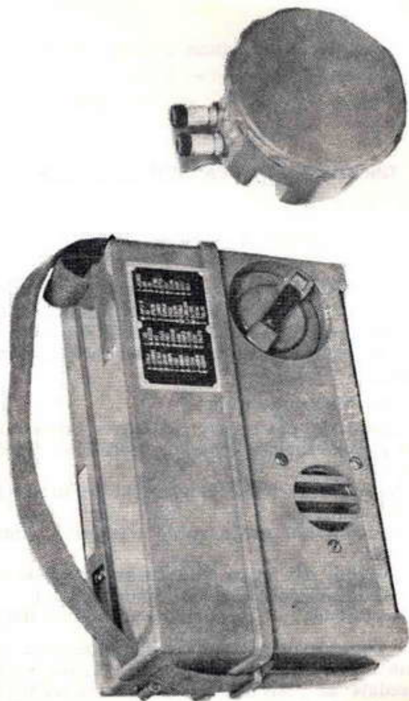
Sl. 1 — Spoljni izgled induktorskog telefona M-63 i brojčanika BN-1
